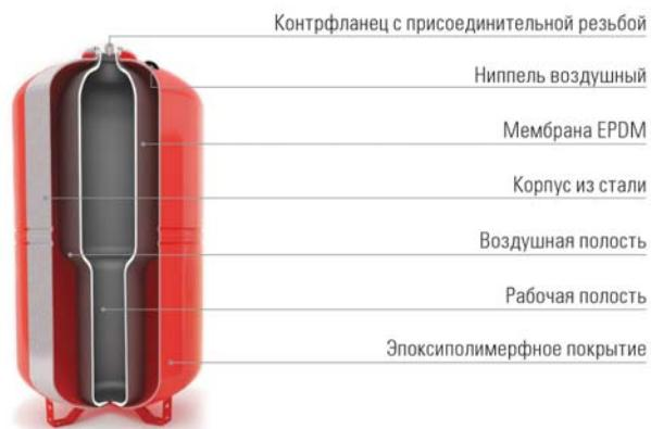
Рис. Расширительный бак торговой марки Wester для систем отопления
